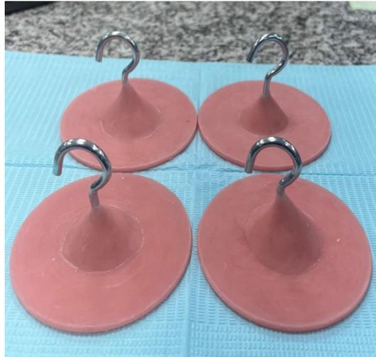
Figura 3. Disco de anillo de metal en el disco de acrílico
