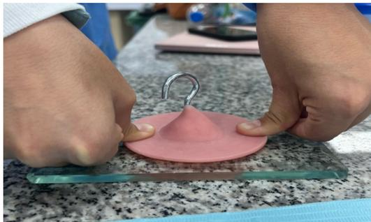
Figura 7. Colocación del disco cargado encima de la loseta de vidrio
