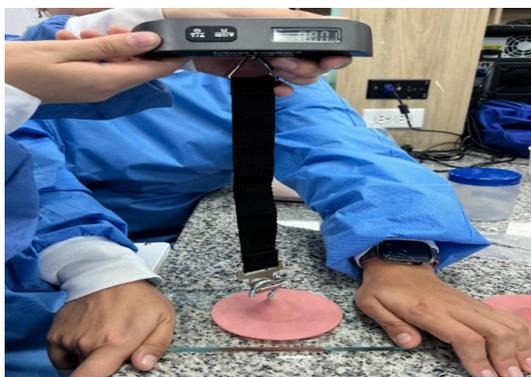
Figura 9. Forma para sostener la loseta para tirar del disco mediante la báscula
